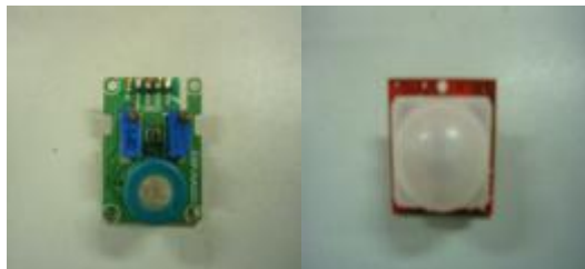
Fig. 13 CO 2 & Temperature module
