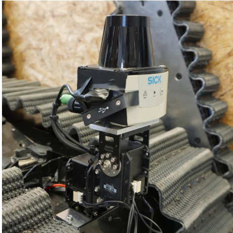
(d) Leveling platform
