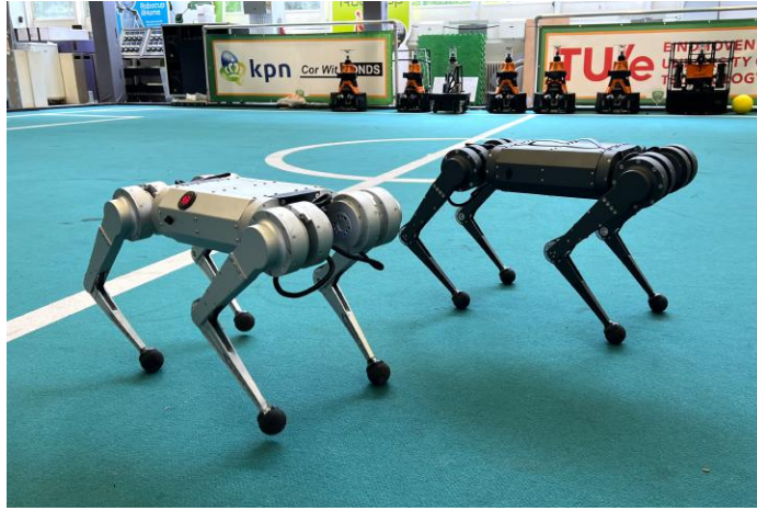
Fig. 2: MIT Mini Cheetah quadruped platforms.
